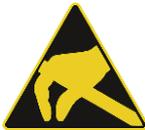
Der Schaltschrank enthält Bauteile und Leiterplatten, die empfindlich auf elektrostatische Entladungen reagieren. Bei der Montage und Wartung sollten ausreichende ESD-Maßnahmen zum Schutz der elektronischen Komponenten getroffen werden (z. B. das Tragen eines Erdungsarmbandes).
