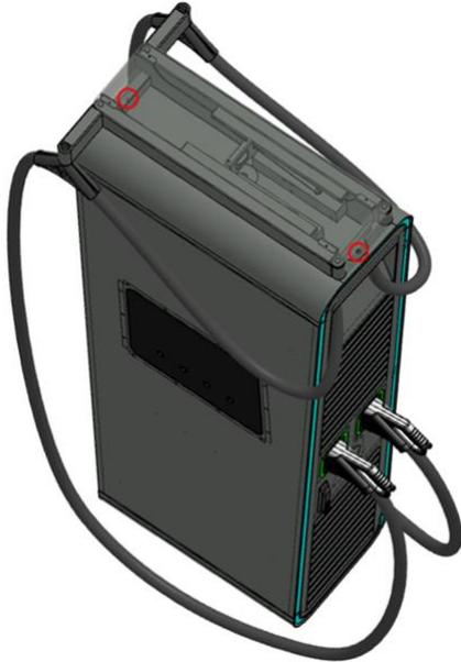
**Abbildung 5:** Position der Schrauben HYC\_150
