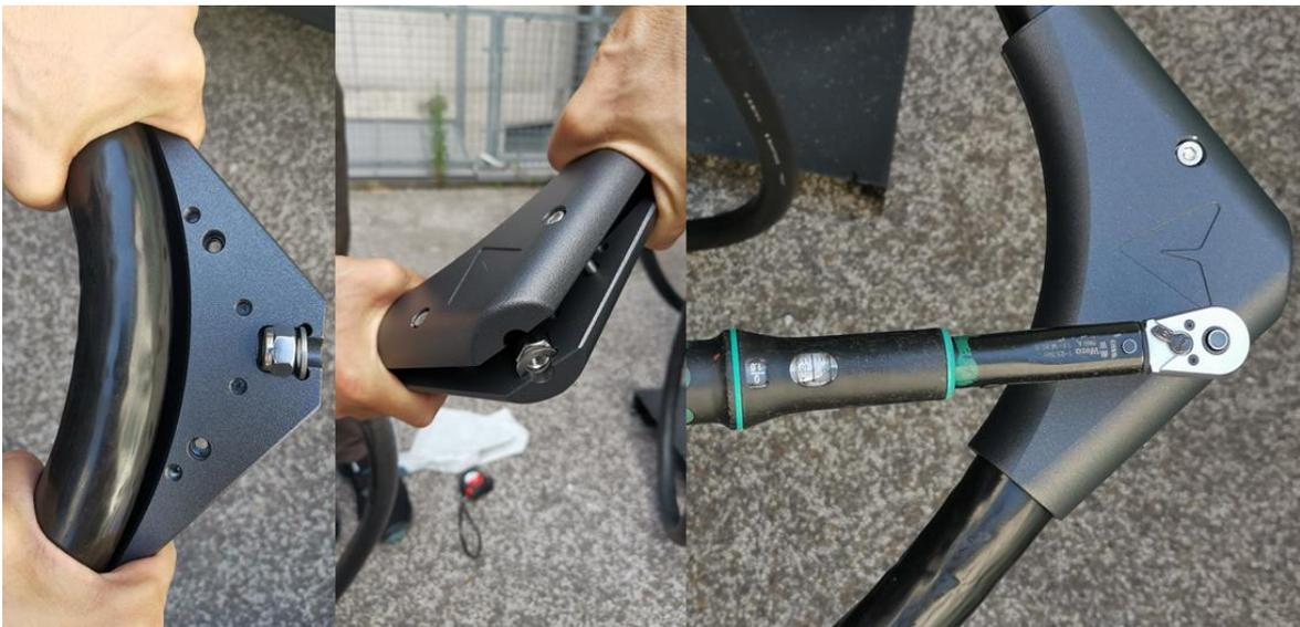
**Abbildung 10:** Anbringen der Kabelhalterung (Frästeil)
